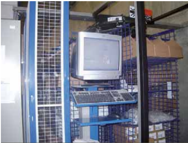
7.24. Panel de control para un sistema de almacenamiento automatizado (carrusel) en almacén general hospitalario.
