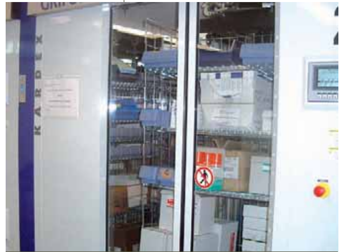
7.25. Zona de presentación de productos en un sistema automatizado de almacén de farmacia hospitalaria.
